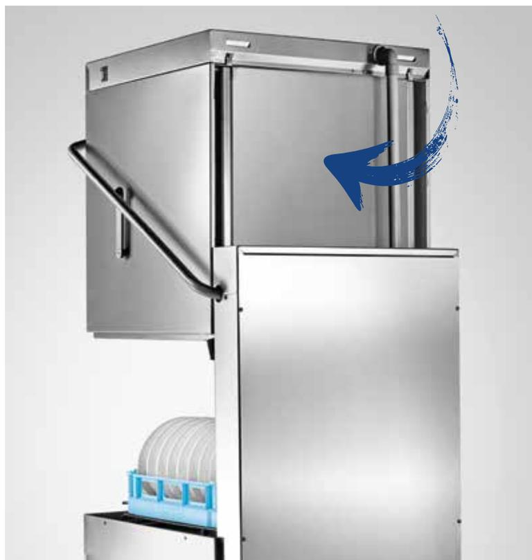
Anche durante l'esercizio, il calore presente viene mantenuto all'interno del sistema. L'acqua di lavaggio non si raffredda sulle pareti della capote, spesse 15 mm. Così aumenta lo sfruttamento del calore e quindi si risparmia energia.
