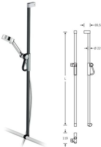
Barre de douche, avec douchette et flexible (1 600 mm), pour montage mural sur poignées de maintien et combinaisons de main courante, en aluminium, Ø 22 mm, librement positionnable, avec support de douchette réglable en continu, avec poignée en étrier de forme ergonomique pour une utilisation simple et sûre sans mouvement rotatif, sans maintenance, force de pression ajustable pour le réglage de hauteur et de l'inclinaison, avec support mural en zinc moulé.
