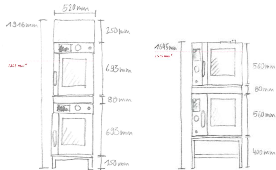
Station CombiMix avec JOKER et panneau de commande sur le dessus avec KHI sur un support de 150 mm.
