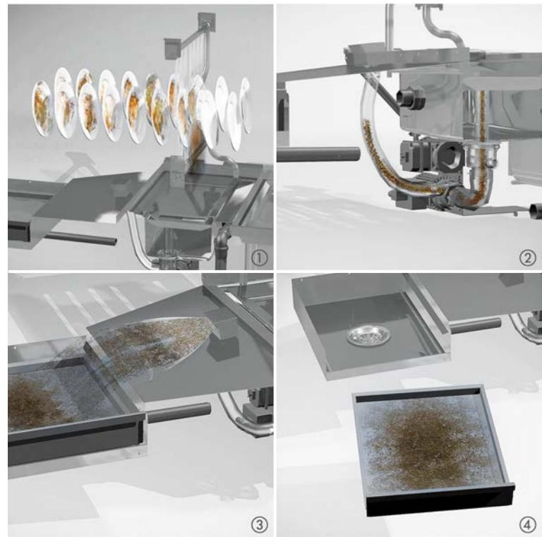
**Phase ①:** Grobverschmutzung wird bereits in der Vorwaschung vom Spülgut abgespült.
